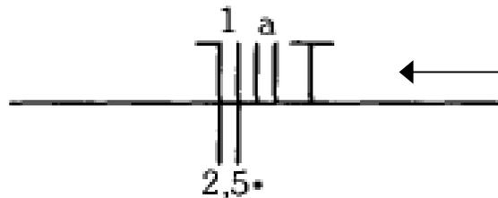
Sequência correta para a representação na forma unifilar: primeiramente representa-se o neutro, após a(s) fase(s) e posteriormente o(s) retorno(s) e, por último, o condutor de proteção (terra)
