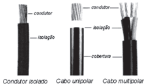
Figura 43 – Cabos utilizados em interligações elétricas dos motores dos ventiladores
