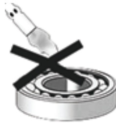
Figura 28 – Exemplo de aquecimento incorreto
