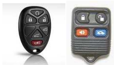
Figura 4.37 Controle remoto automotivo para abertura de portas. O modo de operação é superregenerativo devido ao baixo consumo de potência, além de usar poucos componentes (dimensões pequenas e de mais baixo custo).
