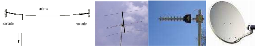
Figura 3.19 – diferentes tipos de antenas. Dipolo, Yagi, helicoidal, parabólica.
