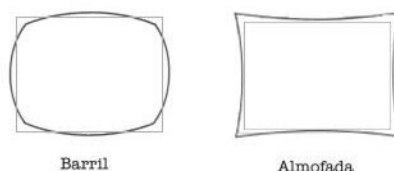
Figura 4.64- Distorções na varredura: Barril e almofada.
