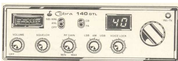
Figura 4.32 - Receptor CB AM- SSB 40 canais. Notar o botão voice lock para eliminação do erro de sincronismo na demodulação (ajuste fino).
