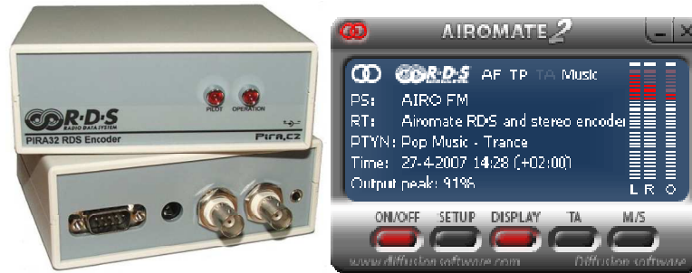
Figura 7.162 – a) Hardware de um sistema RDS para acoplamento ao transmissor FM (vista frontal e vista traseira). b) Modelo típico de receptor RDS em automóveis: Informações da programação são disponibilizadas (estéreo, gênero musical: pop, hora 14:28 em 27-4-2007).
