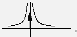
Figura 1.32 - Espectro do sinal \underline{d} (degrau unitário).
