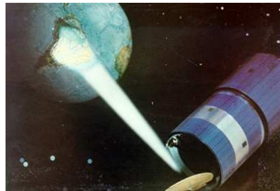
Figura 7.151 – Ilustração da cobertura geográfica de satélite em órbita geoestacionária.
