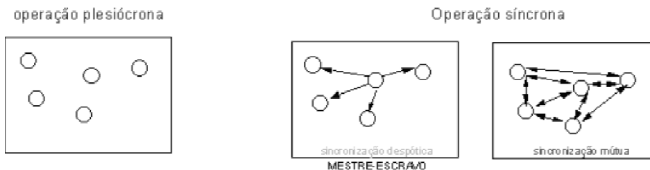
Figura 6.94 - Planos de sincronização. a) sincronismo independente, b) sincronização despótica (mestre-escravo), c) sincronização mútua.
