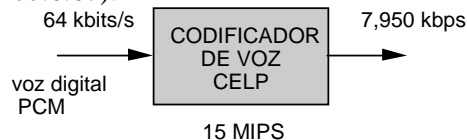
Figura 6.133 – compactação de voz usando um codificador CELP (e.g. padrão IS-54).
