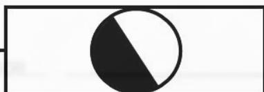
➔ Ponto de circuito vigia no teto sistema tubular (emergência)
