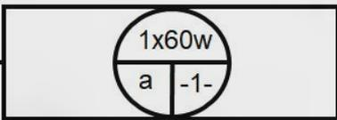
➔ Ponto de luz tubular na parede.
