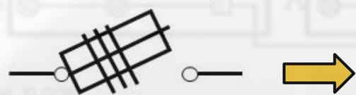
Chave seccionadora com fusíveis (abertura sem carga)
