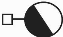
➔ Ponto de circuito vigia na parede (emergência)
