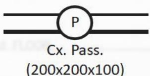
→ Caixa de passagem na parede
