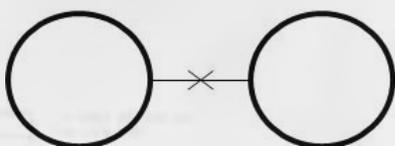
➔ Poste com duas luminárias, para iluminação externa.
