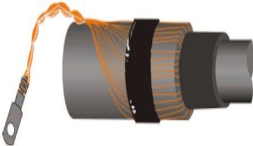
Figura 34. Preparação do aterramento
