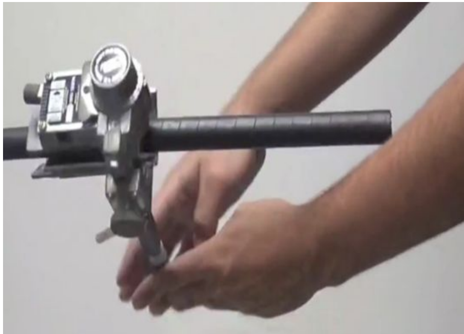
Figura 22. Preparação do cabo Fonte: http://www.kitacessorios.com.br
