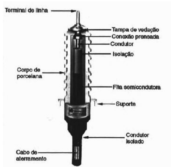
Figura 5. Vista interna de uma mufla Fonte: MAMEDE (2005, p.67)
