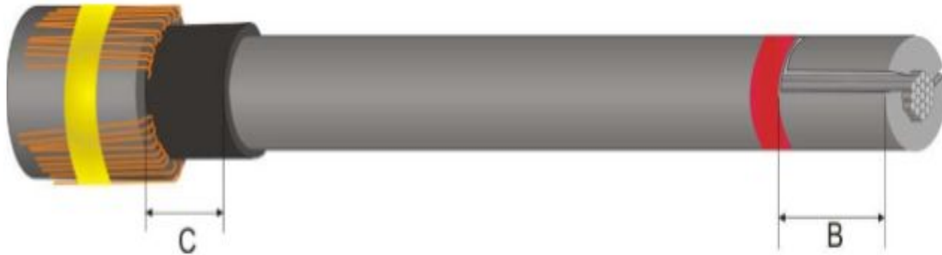
Figura 31. Remoção da camada isolante Fonte: MIT, montagem de terminações, Copel
