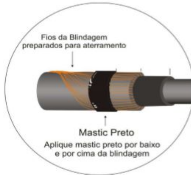
Figura 41. Proteção contra umidade parte inferior
