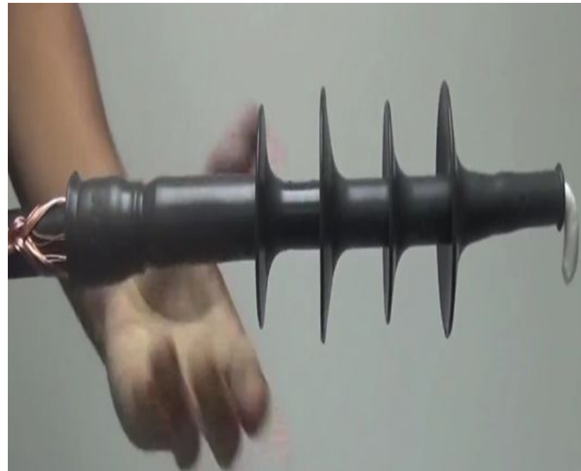
Figura 23. Preparação do cabo Fonte: http://www.kitacessorios.com.br
