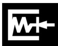
Fig. 2: Indicador de "Mola carregada"
