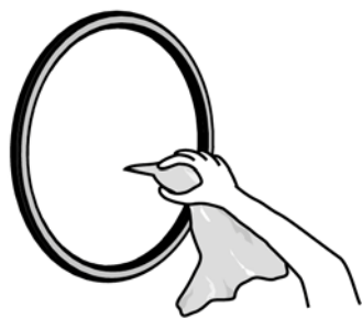
Fig. 92: Limpar os anéis de vedação toroidais
