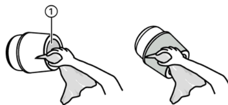
Fig. 91: Limpe o dummy plug roscado de silicone com a luva encaixável
