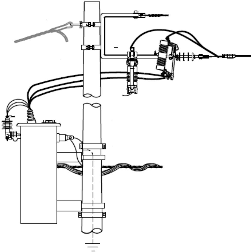
Para a instalação de transformadores trifásicos em fim de rede é empregado a estrutura CE3.
