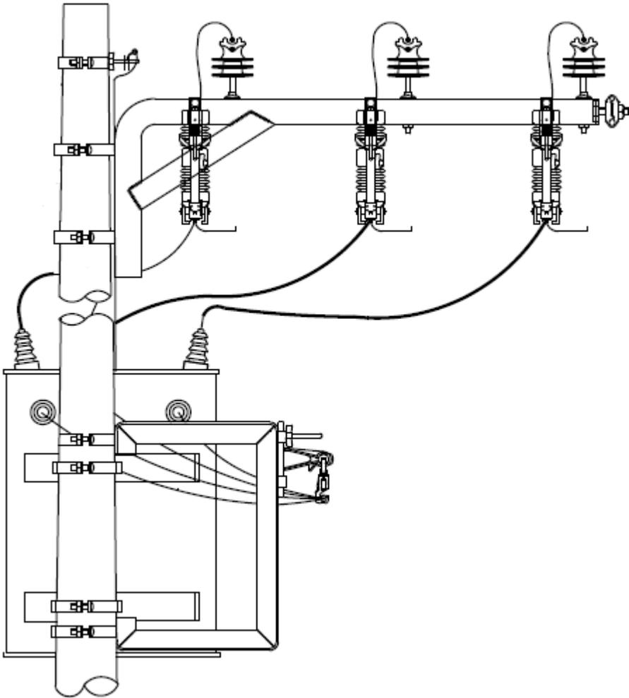
Para a instalação de transformadores trifásicos é empregado a estrutura CEJ2.
