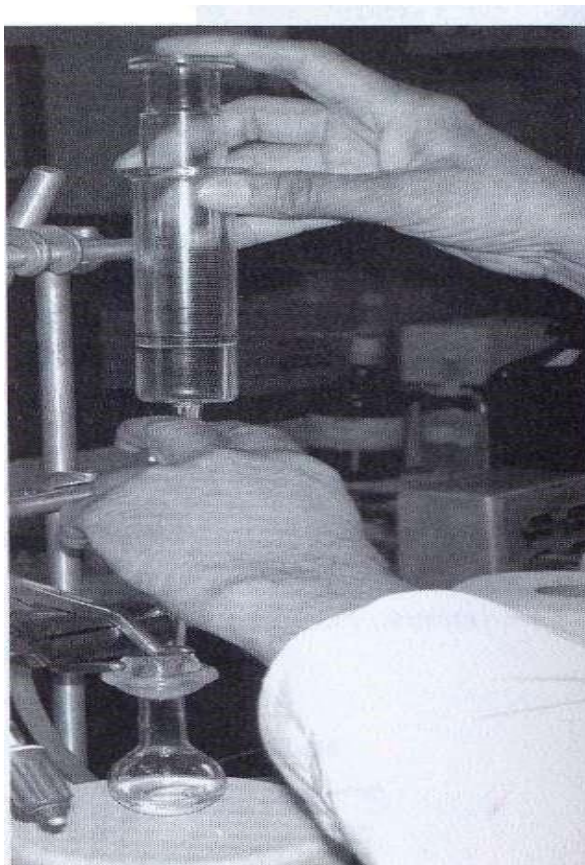
Figura 20- Injeção da amostra de óleo no aparelho de extração com uma seringa.
