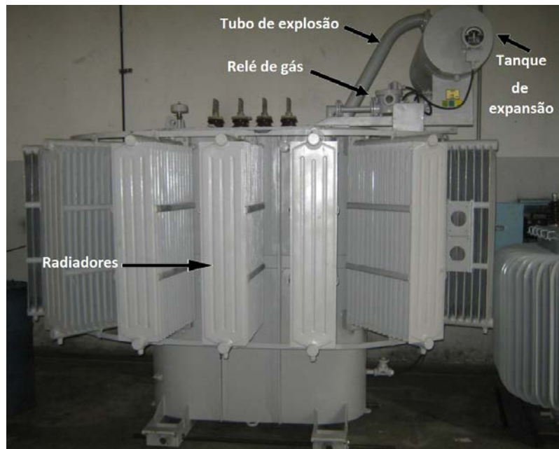
Figura 3.16 – Tanque de expansão, tubo de explosão, relé de gás e radiadores
