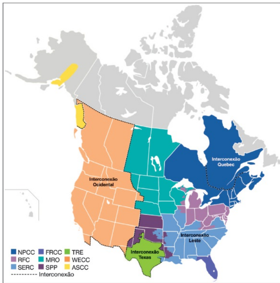
FIGURA 6.3 Mapa com os quatro operadores do sistema de transmissão norte-americano e canadense.
