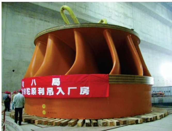
FIGURA 3.11 Turbina Francis da hidrelétrica de Três Gargantas, na China.
