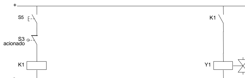
Figura 36 - Memorização das sinais na parte pneumática
