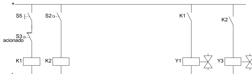
Figura 37 - Memorização dos sinais na parte pneumática
