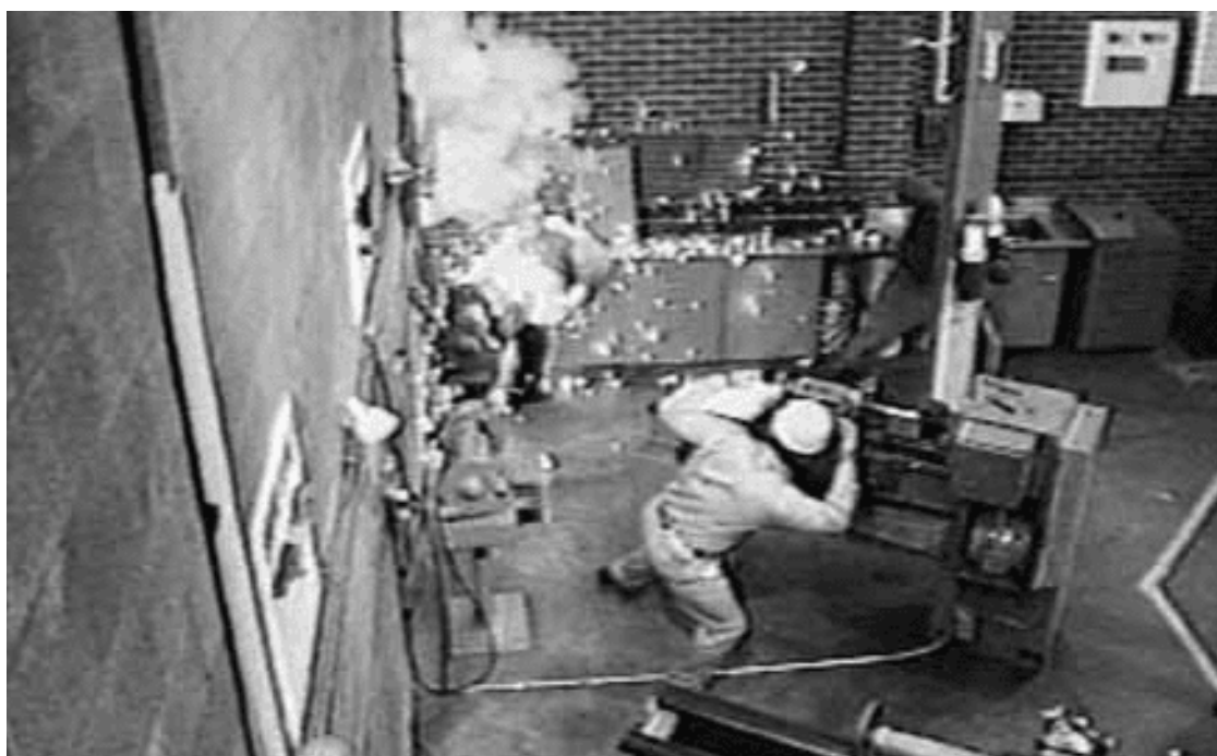
Arco elétrico BT
