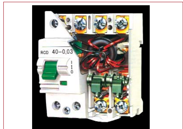
Vista em corte de um interruptor diferencial tetrapolar
