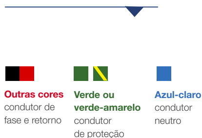
Figura 7: Cores padronizadas para condutores de baixa tensão
