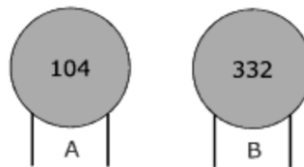
Figura 4.7 - Capacitores A e B com padrões de numeração.
