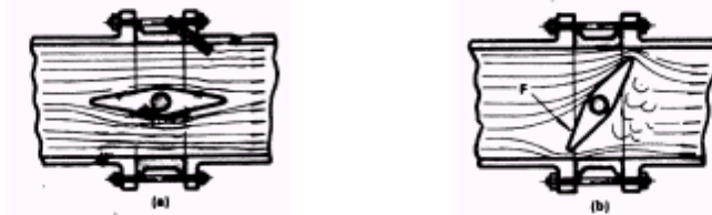
Fig. 25 – Resistência ao fluxo, na válvula borboleta: (a) quando totalmente aberta; (b) Quando parcialmente aberta.
