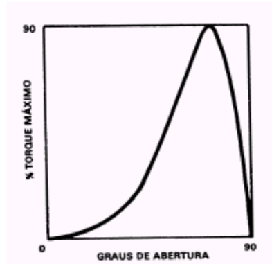
Fig. 26 – Gráfico do Torque VS abertura da válvula borboleta.
