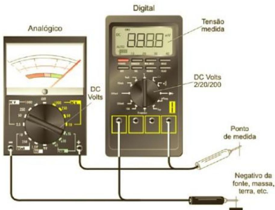
Figura 10 – Medindo a tensão num circuito
