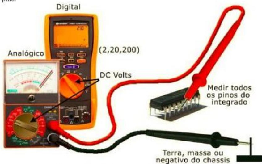
Figura 85 – Medindo tensão no pino de um circuito integrado
