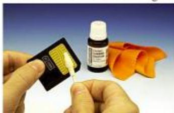
Figura 27 – Limpando contatos com substância especial
