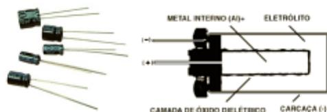
Figura 70 – Tipos comuns de eletrolíticos e sua construção interna.
