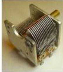
Figura 20 – Um capacitor variável de equipamento antigo.
