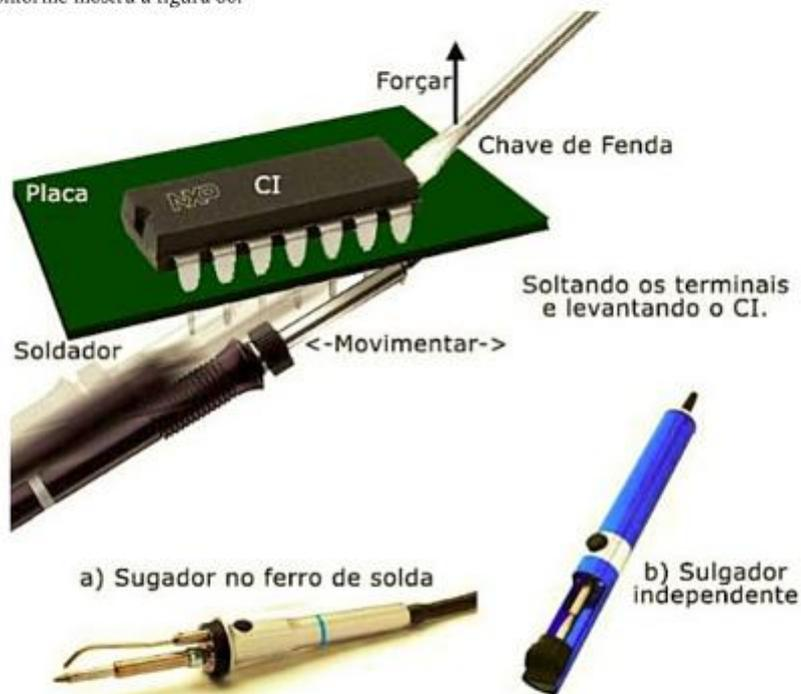
Figura 86 – Extraindo um circuito integrado
