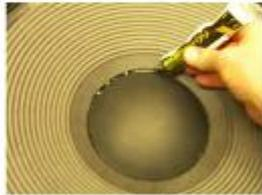
Figura 23 – Reparando cone de alto-falante com cola especial
