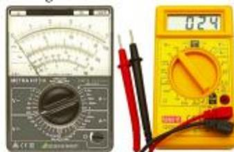
Figura 7 – Um multímetro analógico e um multímetro digital
