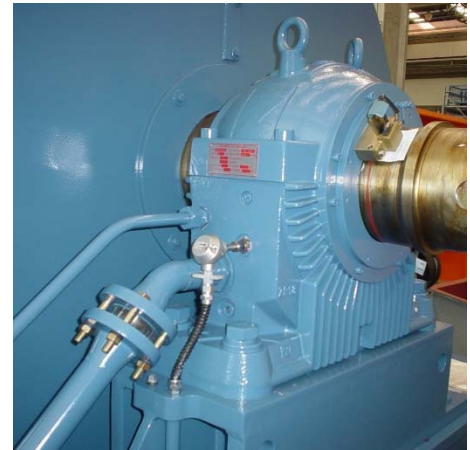
Figura 4.7: Mancal de bucha com circulação externa de óleo.
