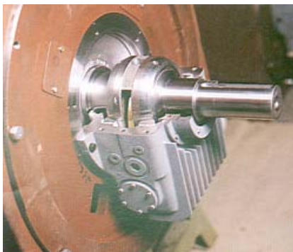
Figura 4.4: Gerador linha S com mancal de bucha aberto para inspeção
