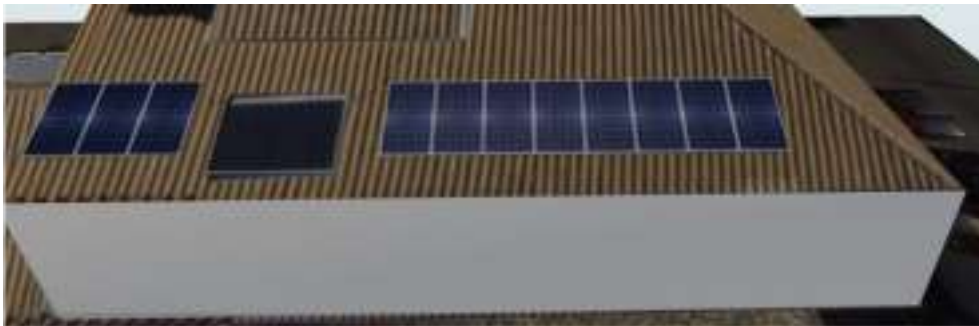
Figura 3: Módulos de um mesmo string (ligados em série) fisicamente distanciados sobre um telhado residencial.
