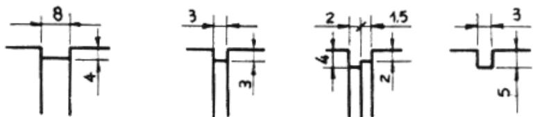
Dimensionamento de canaletas e rasgos
