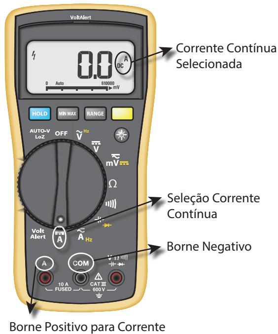
Figura 36 - Multímetro na escala de ampère Fonte: SENAI-SP (2012)
