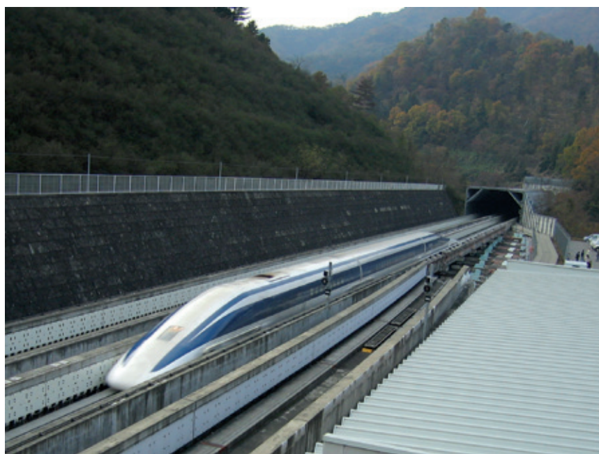
Figura 109 - Trem japonês cujo movimento é baseado no princípio da força de repulsão dos ímãs (linha de teste de Yamanashi) Fonte: Wikimedia Commons (2012).
