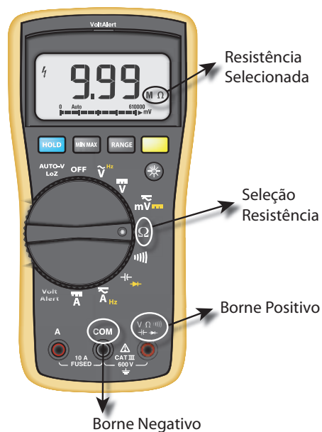
Figura 49 - Multímetro usado como ohmímetro Fonte: SENAI-SP (2012)
