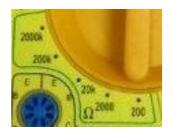
Essa escala é para medição de valores de resistência de um circuito e é dividido como a escala da tensão, em submúltiplos. Quanto maior a escala no multímetro maior o valor da resistência.
