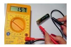
OBS: Nesse caso se inverter a posição das pontas de prova o valor no display ficará com um sinal negativo (-) indicando a inversão. Essa função é
