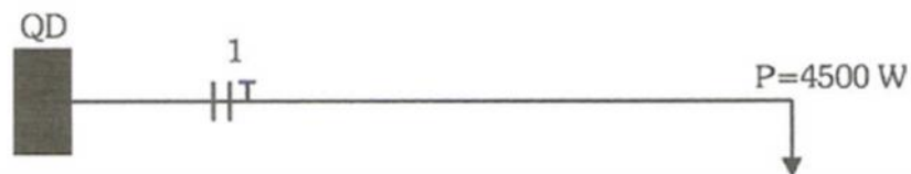
Figura 7.1 - Circuito Terminal de Chuveiro Elétrico.
