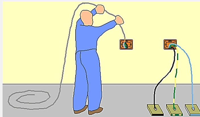
Figura 9.14 Enfiamento em instalações embebidas Puxando os cabos Fonte: [AAT-CIE,2006]
