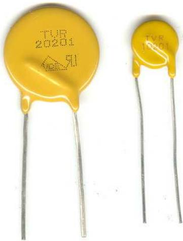
**Varistor:** (MOV – Metal Oxid Varistor): Os varistores são corpos cerâmicos altamente densos com características não-ôhmicas. Sua função é restringir sobretensões transitórias, ou seja, tem a função de manter o valor do potencial elétrico quando ocorre um grande aumento no campo elétrico aplicado.
