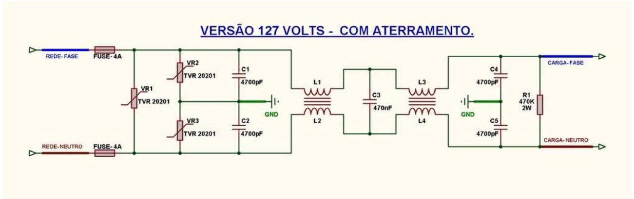
Obs: O varistor VR3, que interliga Neutro e Terra, pode ser substituído por um com a menor tensão de serviço possível, em torno de 15 a 30 Volts. Porém terá de tomar muito cuidado com a polarização da entrada, pois se a mesma for invertida, provocará um curto rompendo o fusível, e possivelmente destruindo o varistor.
