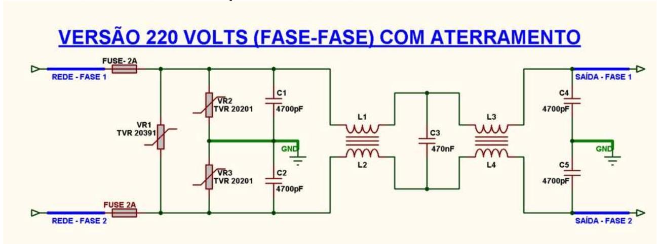
A placa de circuito impresso servirá para todas as versões, sendo que nas que não dispõem de aterramento, a trilha central poderá ser descartada.
