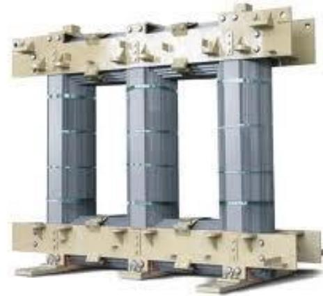
Cada uma das lâminas é isolada com uma espécie de verniz, para evitar o contato elétrico entre as chapas prevenindo o transformador de perdas por Histerese e Foucault.
