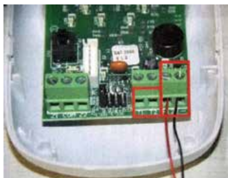
Fig 77 - fios positivo e negativo
