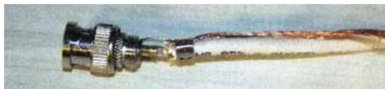
Fig 110 - Malha presa no conector
