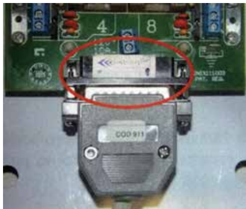
Fig 120 - Entrada DVR para conectar o Stand Alone
