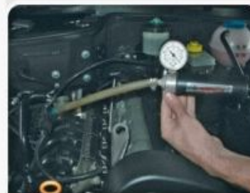
F5.1 - Bomba de vácuo conectada ao CMD.
