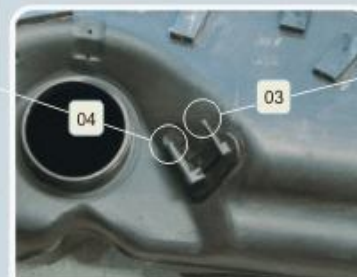
Detalhe dos terminais do tanque de combustível
