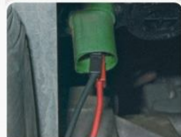
F.3.2 - Procedimento para medir a resistência do sensor ECT.
