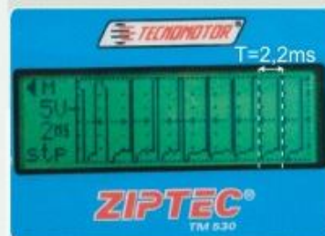
Sinal de alimentação do motor de corrente contínua do ETC após uma aceleração.
