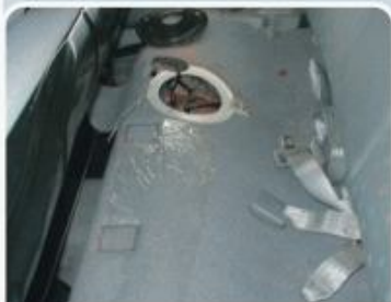
Localização do acesso à bomba de combustível, embaixo do banco traseiro.
