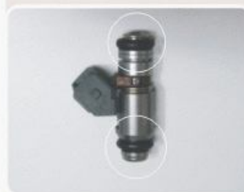
F.4.5 - Inspeção do anel O'ring.
