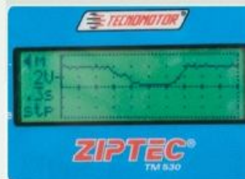
Sinal de resposta do potenciômetro 2 do ETC após abrir e fechar a borboleta.
