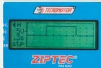
Sinal de resposta do interruptor 1 do pedal do freio após pisar e soltar o freio.
