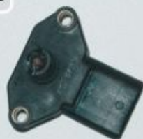
Conjunto medidor de densidade
