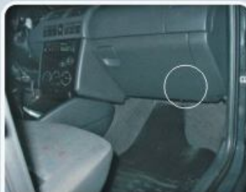
Localização do acesso ao relé principal do sistema de injeção.
