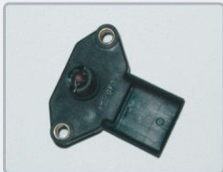
Conjunto medidor de densidade
