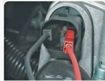
E.3.1 - Medida da resistência elétrica do potenciômetro 1 do ETC.
