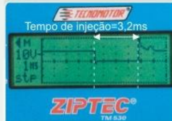
Sinal do pulso de acionamento do eletroinjeter em marcha lenta.
