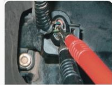
F.1.2 - Procedimento de medida da frequência do sinal do sensor CKP.
