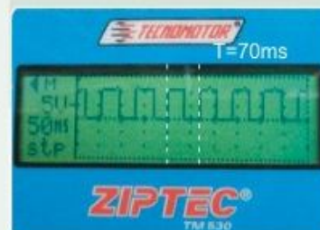
Sinal do sensor de velocidade (VSS - tipo Hall) para a velocidade de 10 km/h.
