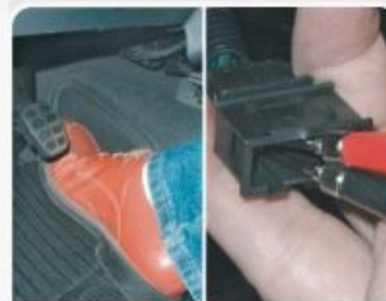
E3.3 - Medida da resistência elétrica do potenciômetro 1 do sensor SPA com o pedal do acelerador acionado.
