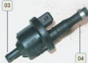
Eletroválvula de purga do canister: é utilizada para controlar a vazão de vapor de combustível para o coletor de admissão.
