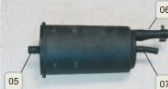
Canister - Filtro de carvão ativado responsável pela absorção de vapores de combustível evitando a poluição atmosférica.
