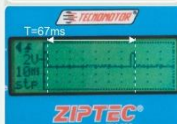
Sinal do pulso de acionamento da bobina de ignição em marcha lenta.
