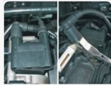
F.1.1 - Centelhador instalado no terminal de alta tensão referente ao cilindro 1.
