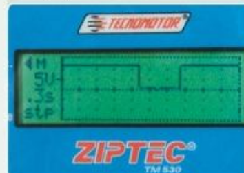
Sinal de resposta do interruptor 2 do pedal do freio após pisar e soltar o freio.
