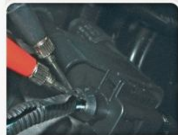
F.1.2 - Procedimento de medida da frequência do sinal do sensor CMP.
