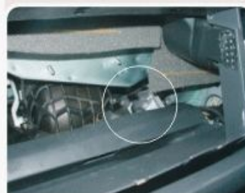
Acesso ao MC: através da tampa plástica.
