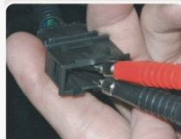
F.3.1 - Medida da resistência elétrica do potenciômetro 1 do sensor SPA.
