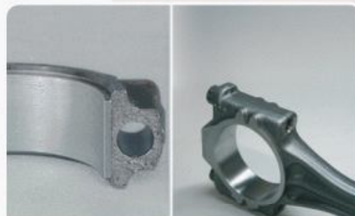
Biela "fraturada" - sua separação é feita através do princípio da fratura controlada, ao invés dos tradicionais processos.
