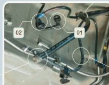
Mangueiras conectadas ao tanque de combustível
