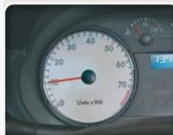
F.1.1 - Medida da rotação do veículo.
