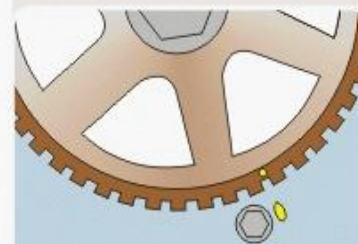
F8V.1 Alinhamento do comando de válvulas com o ressalto do bloco do motor.
