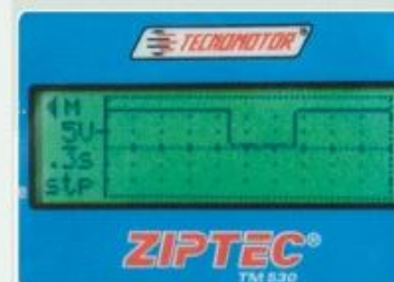
Sinal de resposta do interruptor do pedal de embreagem após pisar e soltar a embreagem.
