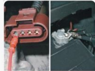
F.2.2 - Medida da tensão de alimentação do sensor HEGO.
