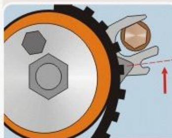
F16V.7. Detalhe do tensor da correia principal, ressaltando a referência de tensionamento.
