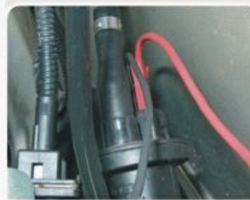
F.3.4 - Aplicação da tensão da bateria na CANP.
