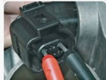
F2.1 - Medida da tensão de alimentação dos potenciômetros do ETC.
