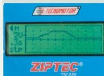
Sinal de resposta do potenciômetro 1 do pedal do acelerador após acelerar e desacelerar.
