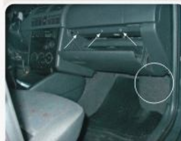
O MC está localizado embaixo do tapete do lado do passageiro. Para removê-lo solte os parafusos da tampa plástica acima do porta-luvas, indicados por setas.
