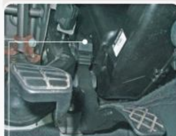
Localização do sensor SPA: fixado no pedal do acelerador.
