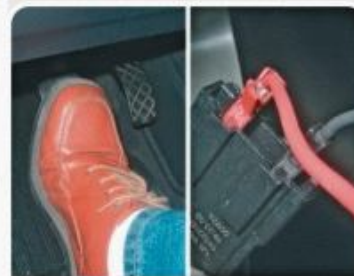
E.2.3 - Medida da resistência do sensor IPF com o pedal do freio pressionado.
