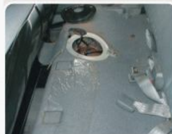
Localização da bomba de combustível.
