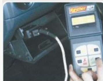
F1.2. - Rasther conectado ao conector de diagnósticos.
