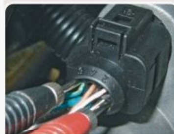
F.1.1 - Medida da tensão de resposta do potenciômetro 1 do ETC.
