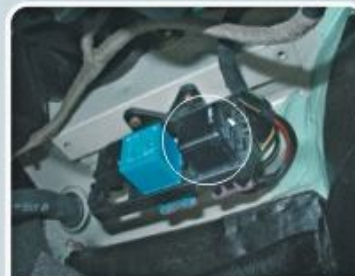
Relé principal do sistema de injeção (relé preto): fixado debaixo do porta-luvas.
