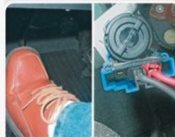
F.2.3 - Medida da resistência do sensor CPP com o pedal da embreagem pressionado.
