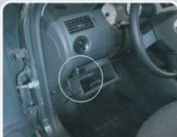
Localização da caixa de relés e fusíveis
