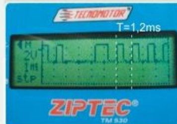
Sinal do sensor de posição da árvore de manivelas (CKP - tipo Hall) em marcha lenta.
