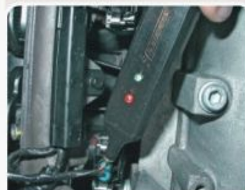
F.3.2 - Procedimento de verificação dos pulsos durante a partida.
