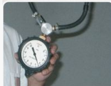
F.2.b - Manômetro instalado na linha de pressão.
