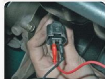
F.2.1 - Procedimento de medida da tensão de alimentação do sensor CKP.
