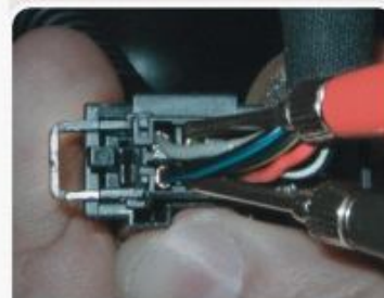
F.1.1 - Medida da tensão de resposta do potenciômetro 1.
