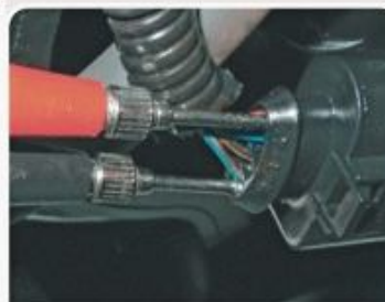
F.2.1 - Procedimento de medida da tensão de resposta do sensor de pressão.
