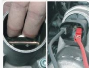
E.3.3 - Medição do potenciômetro 1 do ETC.
