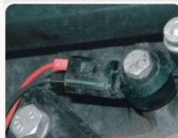
F.1.2 - Procedimento de medição da tensão de resposta do sensor KS.
