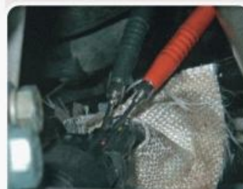
F.1.2 - Procedimento de medida da frequência do sinal do sensor VSS.
