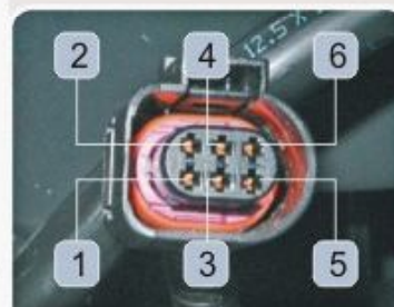
Terminal elétrico da borboleta motorizada.
