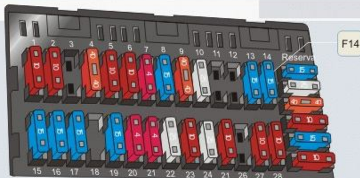
Fusível (F14): protege o relé principal do sistema de injeção
