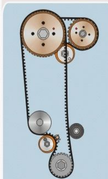
F16V.6. Posicionamento da correia dentada nos motores 16 válvulas.
