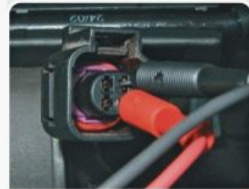
F.2.1 - Procedimento para medir a tensão de alimentação do sensor ECT.
