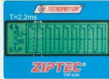
Sinal de alimentação do motor de corrente contínua do ETC em marcha lenta.
