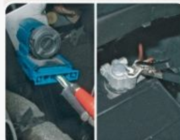
F.1.1 - Medida do sinal do sensor CPP com o pedal da embreagem não pressionado.
