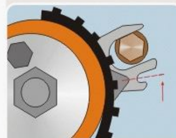
F8V.3 Detalhe do tensor da correia principal, ressaltando a referência de tensionamento.
