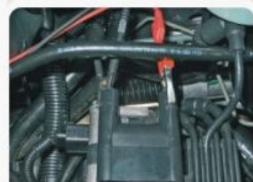
F.2.1 - Procedimento de medida da resistência do secundário da bobina de ignição.
