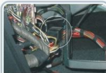
Relés da 1ª e 2ª velocidade do eletroventilador do radiador
