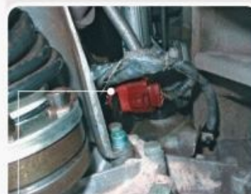
Localização do terminal elétrico do sensor HEGO.
