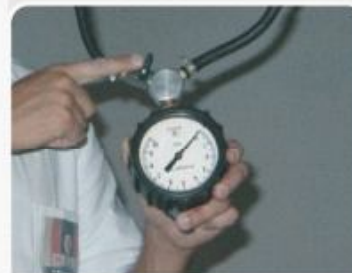
F.1.1 - Manômetro instalado na saída do filtro de combustível com a válvula estranguladora fechada.
