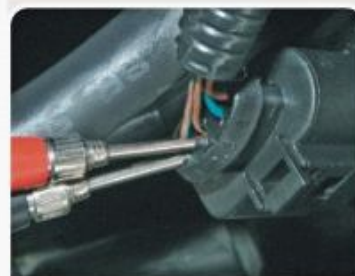
F.1.2 - Procedimento da medida da tensão de resposta do sensor de temperatura.
