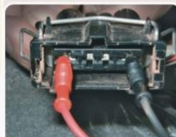
F.3.2 - Procedimento de medida da tensão de alimentação da bomba de combustível.
