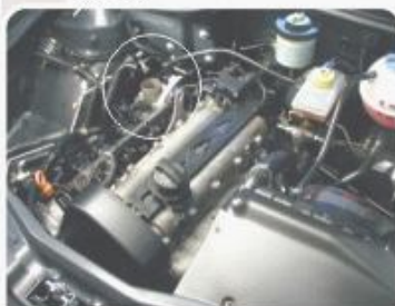
Localização da borboleta motorizada (ETC).
