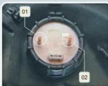
Dutos da bomba de combustível
