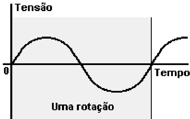
Fig. Variação da tensão (alternada) em função do tempo Curva senoidal
