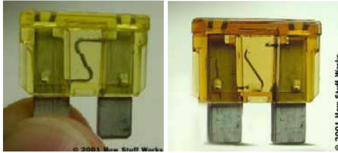
Um fusível bom (esquerda) e um fusível queimado (direita)
