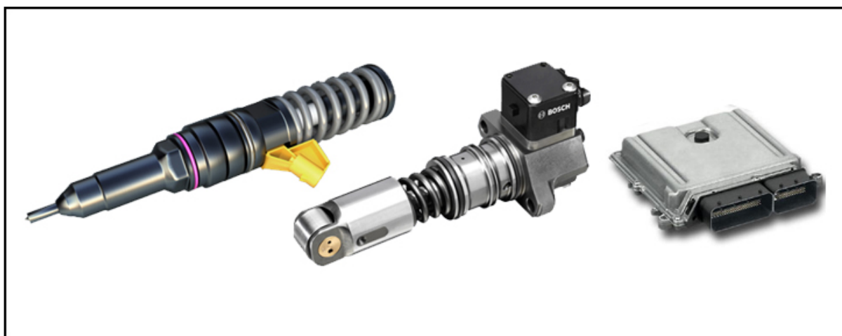
Figura 20 – Componentes do sistema de alimentação diesel por unidade injetora.
