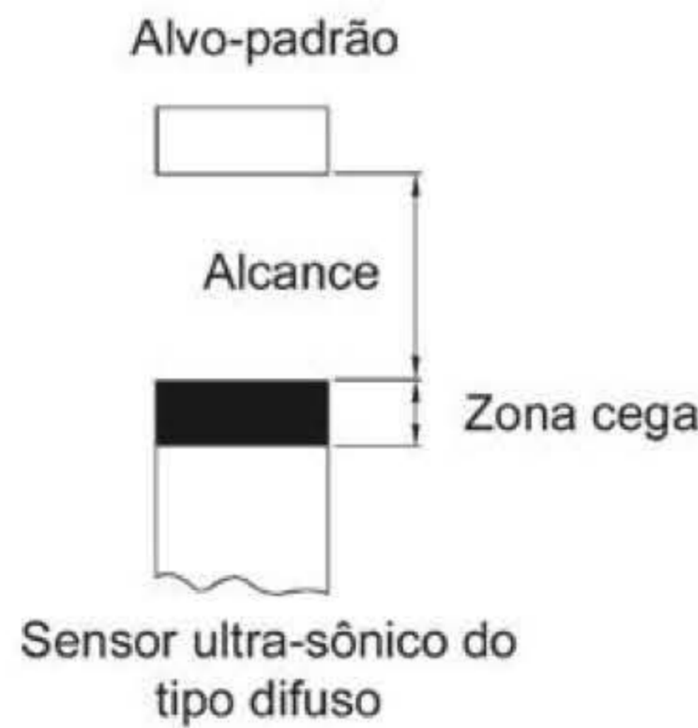
FIGURA 3.24 Faixa de trabalho de um sensor ultra-sônico.
