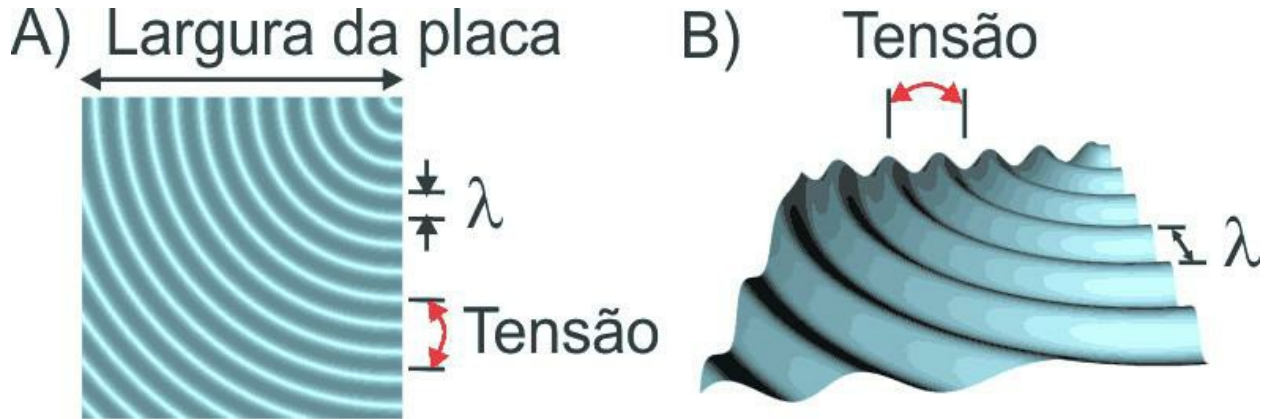
Figura 7.11: Sinal transitando na placa de terra com comprimento maior que o comprimento de onda do sinal. a) vista de cima; b) vista em perspectiva.
