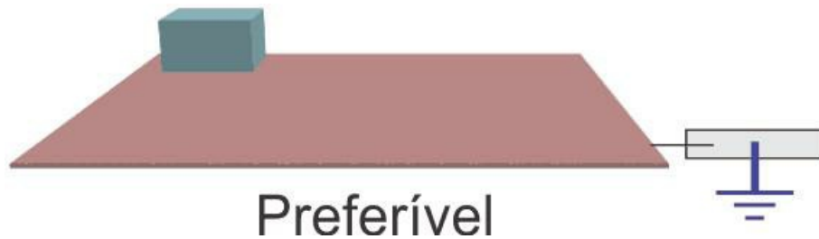
Figura 7.12: Equipamento aterrado por meio de: a) um cabo; b) uma fita e c) um plano condutor
