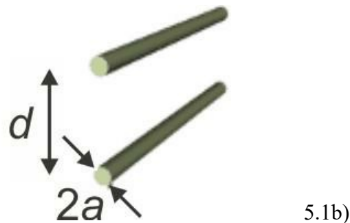
Figura 5.1: Linha de transmissão formada por par de condutores em paralelo. a) v(t) é a tensão elétrica entre os condutores e i(t) é a corrente elétrica circulando nos condutores; b) distância entre os condutores e diâmetro.
