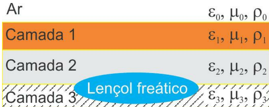
Figura 9.4: Solo estratificado com lençol freático
