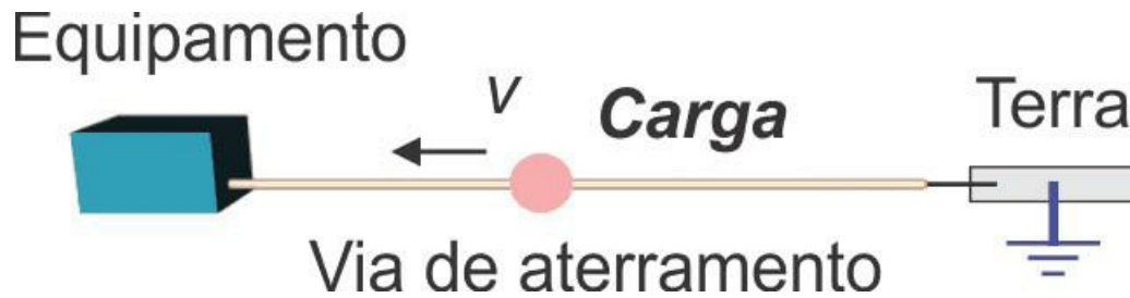
Figura 7.25: A carga elétrica se deslocando a uma velocidade v no sentido do equipamento só irá afetá-lo quando chegar neste.
