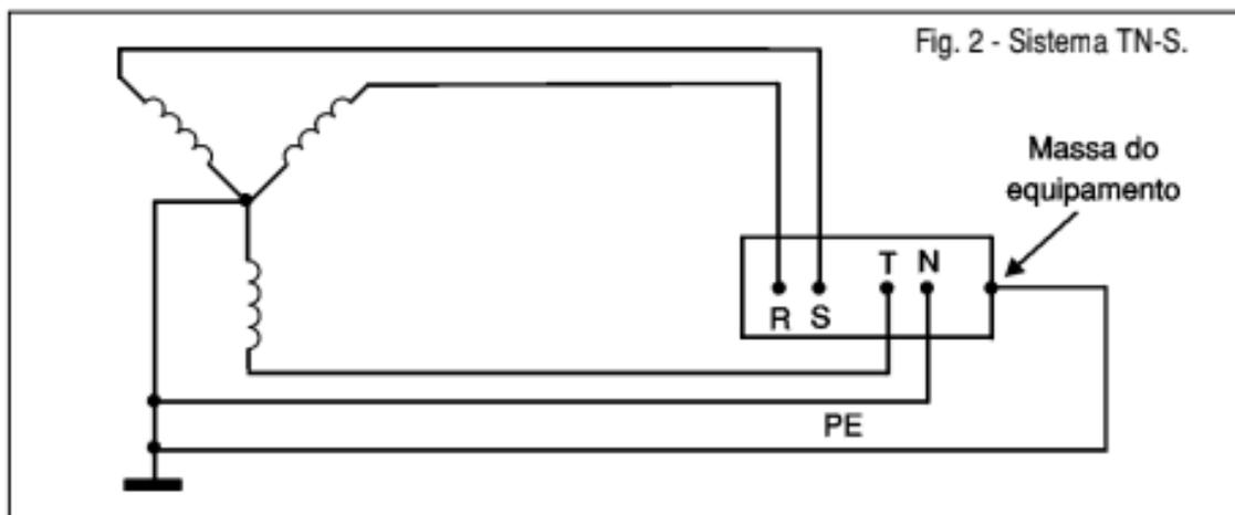
Notem pela figura 2 que temos o secundário de um transformador ( cabine primária trifásica ) ligado em Y. O neutro é aterrado logo na entrada, e levado até a carga .
