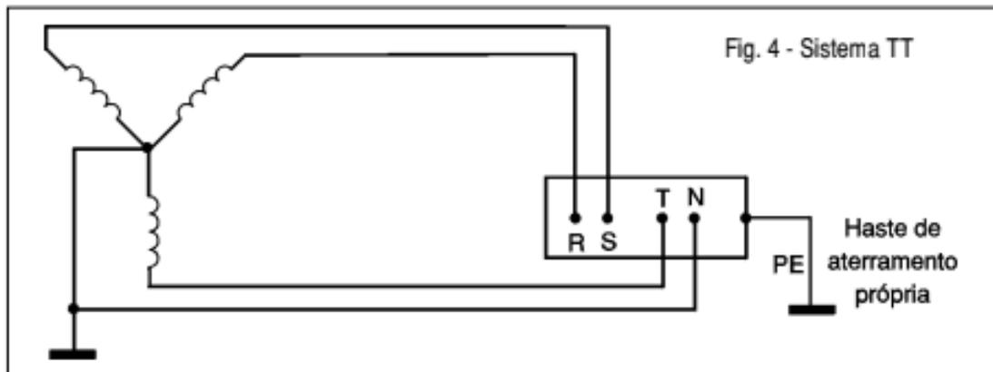
Esse sistema é o mais eficiente de todos. Na figura 4 vemos que o neutro é aterrado logo na entrada e segue (como neutro) até a carga (equipamento). A massa do equipamento é aterrada com uma haste própria, independente da haste de aterramento do neutro.
