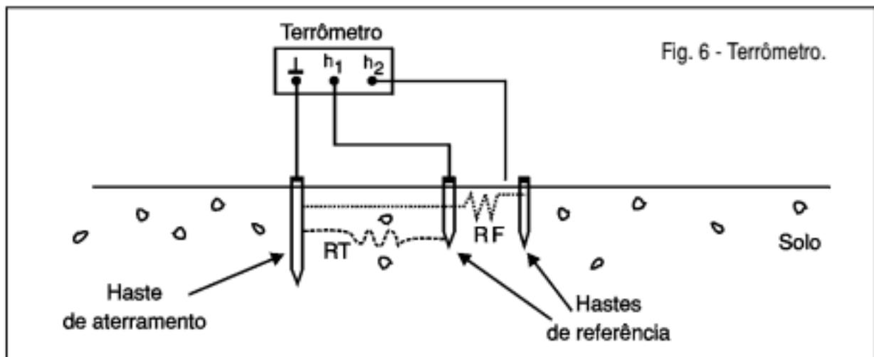
Na verdade, o terrômetro "injeta" uma corrente pela terra que é transformada em "quedas" de tensão pelos resistores formados pelas hastes de referência, e pela própria haste de terra.
