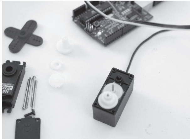
Figura 9.4 – Modificação de servo para obter rotação contínua (imagem por Adam Grieg).
