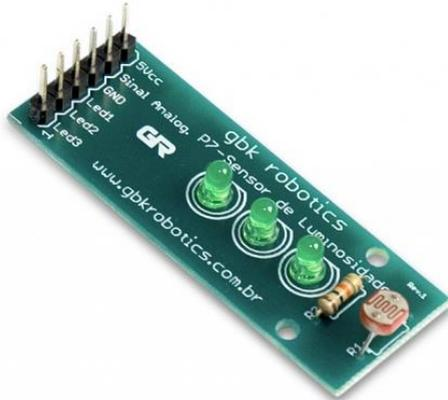
Figura 3.10: Módulo P7-Sensor de Luminosidade
