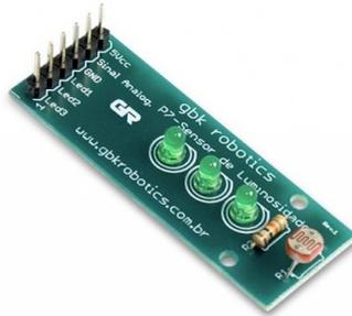
Figura 3.45: Módulo P7-Sensor de Luminosidade
