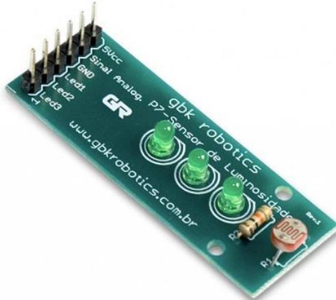
Figura 3.43: Módulo P7-Sensor de Luminosidade
