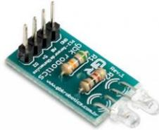
Figura 3.37: Módulo P12-Sensor de Obstáculos
