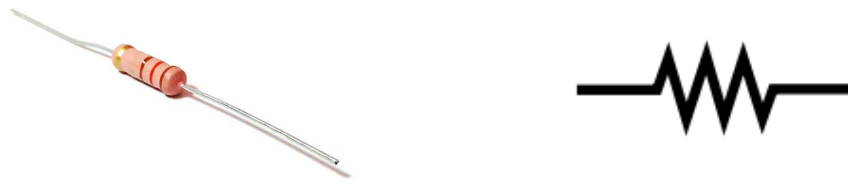
Figura 6.5: Resistor e sua representação em circuitos elétricos.
