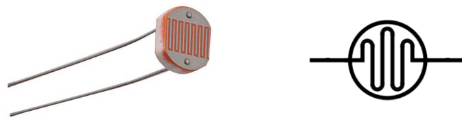
Figura 6.19: LDR e sua representação em circuitos eletrônicos.
