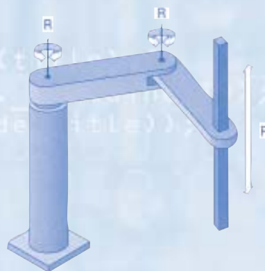
Fig 7 - Eixos de um robô Scara (RRP).
