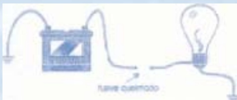
fig. 41 - O circuito está interrompido, devido ao rompimento do condutor no interior do fusível.
