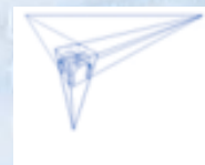
PERSPECTIVA DE TRÊS PONTOS DE FUGA
