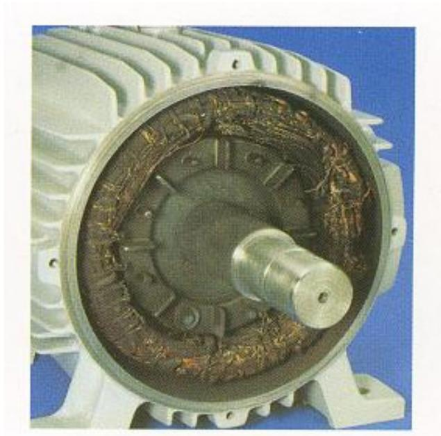
Fig 36 Queima por rotor travado
