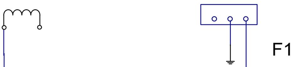
Fig 119 Resistência de isolamento do campo para a massa
