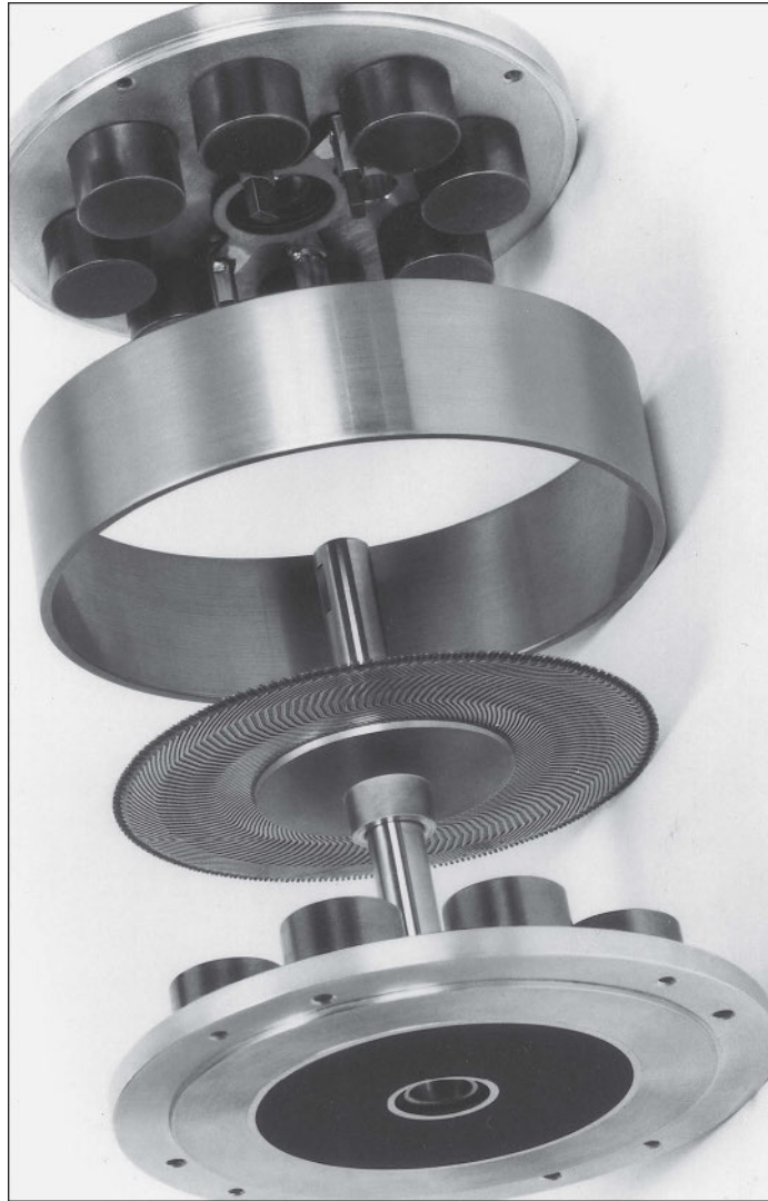
Figura 7.24 Vista explodida de um servomotor de ímã permanente com armadura na forma de disco. Os ímãs são de Alnico. (Foto cortesia da empresa Kollmorgen Corporation.)
