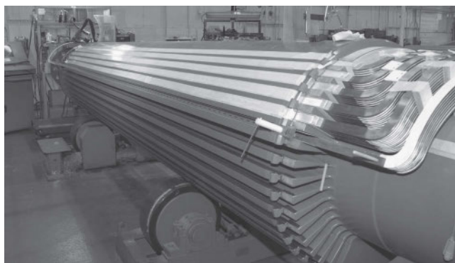
Figura 4.3 Instalação do enrolamento de campo no rotor de um gerador síncrono de 200 MW e 2 polos. (Foto cortesia da empresa General Electric Company.)
