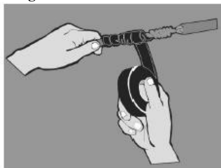
Figura 93 – Isolando a emenda.
