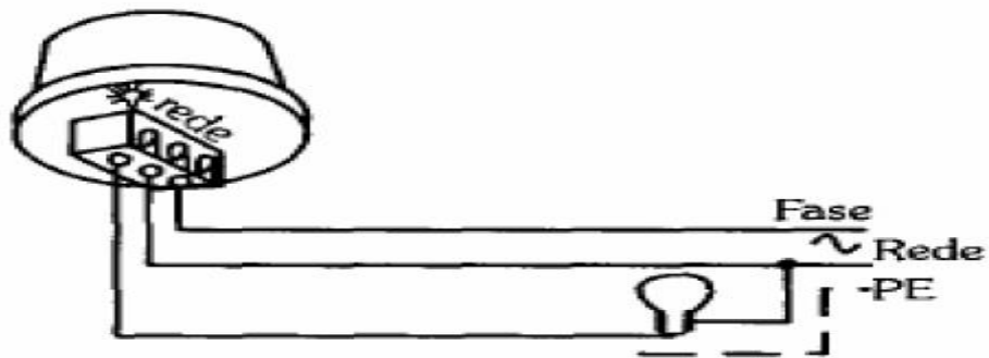
Figura 164 – Relé instalado sem interruptor.
