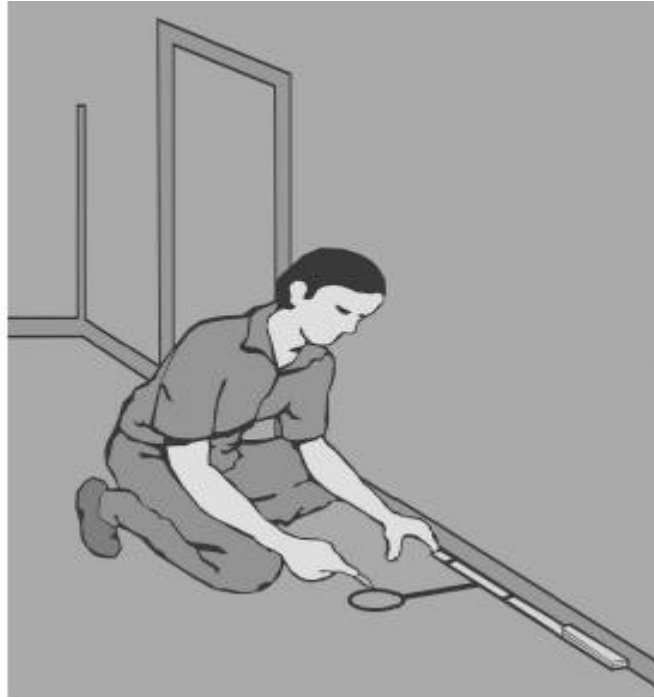
Figura 130 – Marcação da posição do interruptor no piso.
