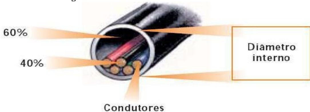
Figura 103 – Condutores no interior do eletroduto.
