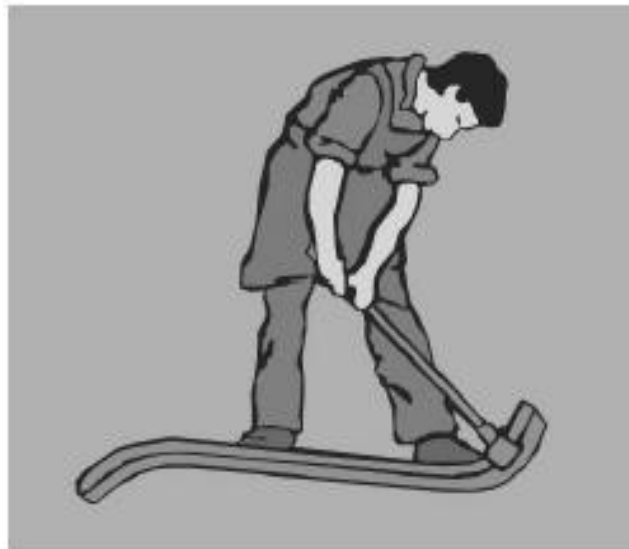
Figura 106 – Curvando o eletroduto.
