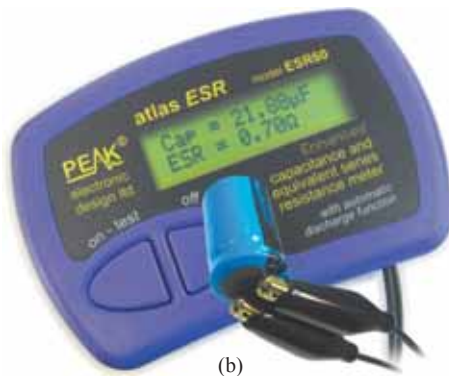
Figura 14.28 ESR. (a) Impacto no modelo equivalente; (b) Instrumento de medição. [Parte (b) por cortesia da Peak Electronic Design Limited.]
