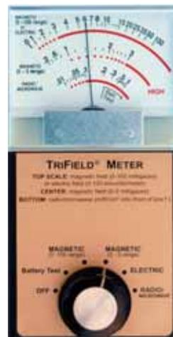
Figura 11.14 Miligaussímetro. (Cortesia do AlphaLab. Inc.)
