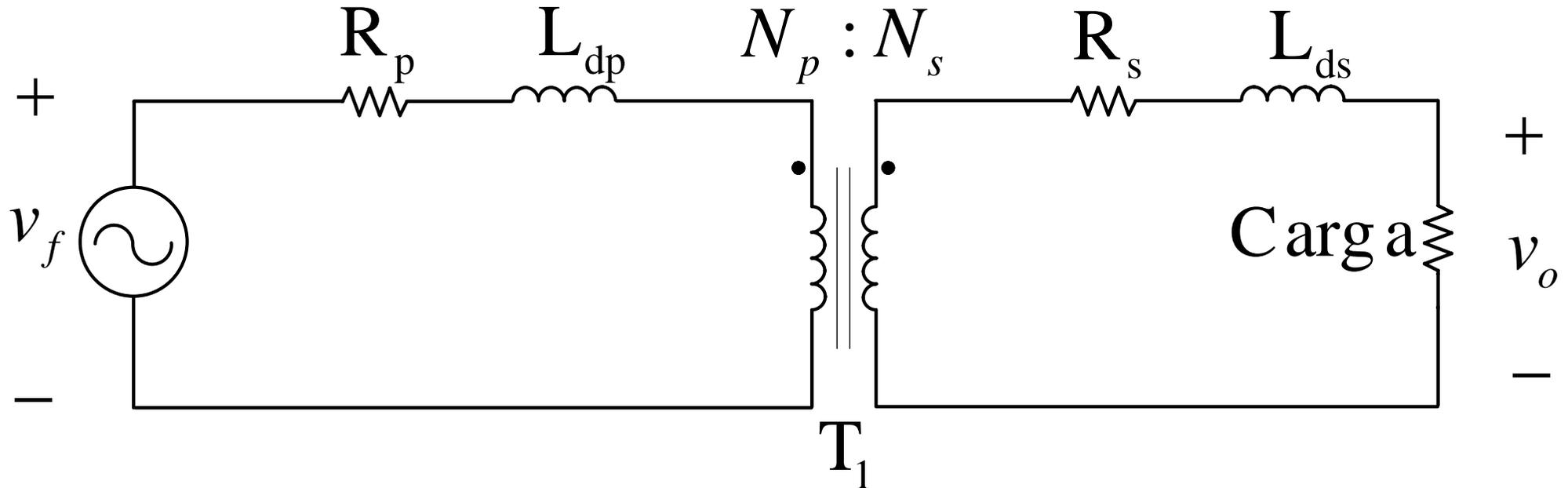
Com carga, a tensão de saída de um transformador é diferente do que na situação em aberto, ou seja, a vazio.
