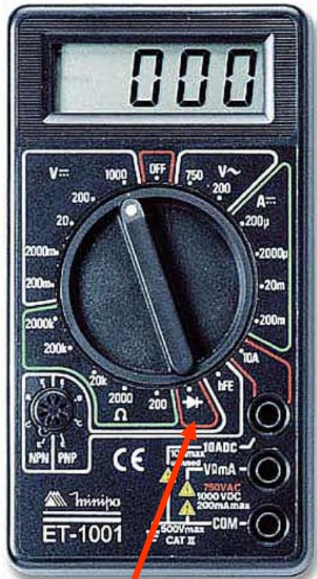
Escala para teste de diodos
