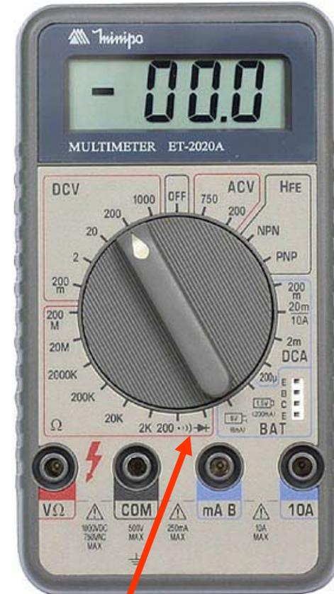
Escala para teste de diodos
