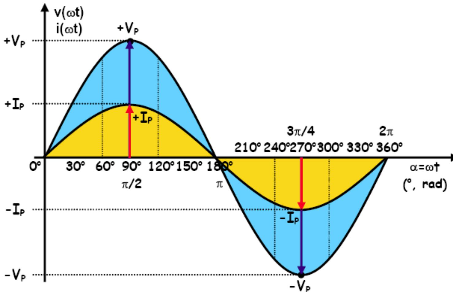
Nos terminais de um resistor, a corrente está sempre em fase com a tensão:
