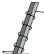
A corrente que causa a dilatação do bimetálico é a corrente do motor elétrico que circula por um condutor ao redor desse bimetálico.
