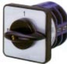
Seu funcionamento mecânico está baseado na utilização de cames acionados por um sistema rotativo. Quando o operador aciona o manípulo esses cames acionam os contatos elétricos mudando suas posições.
