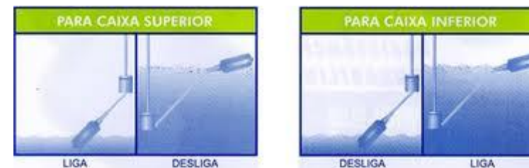
Figura 51: Reservatório utilizando chave boia superior e inferior com contrapeso. Fonte: Disponível em: < http://produto.mercadolivre.com.br/MLB-237772144-chave-boia-25amp-ferpi-boia-de-nivel-p-acionamento-JM >, acesso em 23/11/12.
