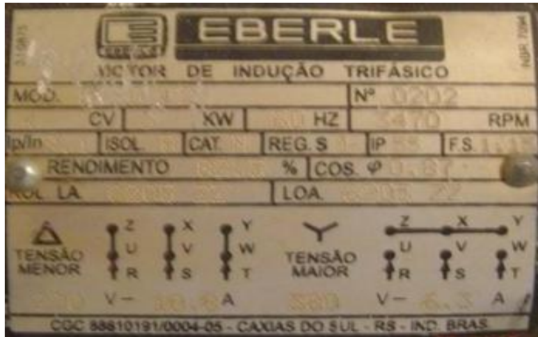
Figura 35: Placa de identificação de motor fabricante Eberle. Fonte: Disponível em: < http://campinas.olx.com.br/motor-eletrico-de-inducao-trifasico-eberle-iid-107427084 >, acesso em 20/11/12.
