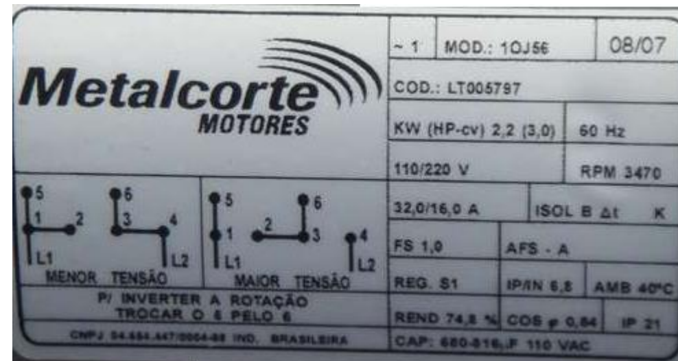
Figura 34: Placa de identificação de motor fabricante Metalcorte. Fonte: Disponível em: < http://www.preciolandia.com/br/motor-eletrico-monofasico-3-cv-3500-rpm-736fte-a.html >, acesso em 20/11/12.
