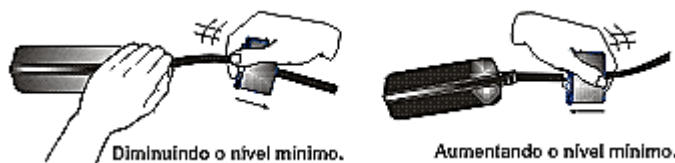
Figura 49: Exemplo de ajuste do nível máximo e mínimo da chave boia com contrapeso. Fonte: Disponível em: < http://www.margirius.com.br/manual_cb.aspx >, acesso em 23/11/12.
