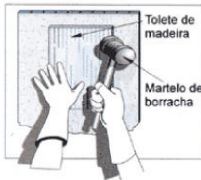
Figura 23. Bater levemente a placa.
