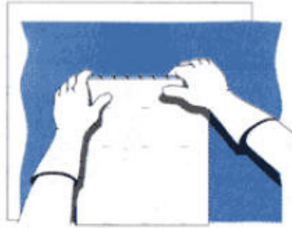
Figura 22. Posicionamento e colocação da placa de pastilhas.
